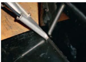
Petit outil à main pour le soudage des matériaux thermoplastiques pour les fabricants de plastique. Alimentation en air avec un ventilateur externe (BAK-Air Station) ou avec air comprimé.
